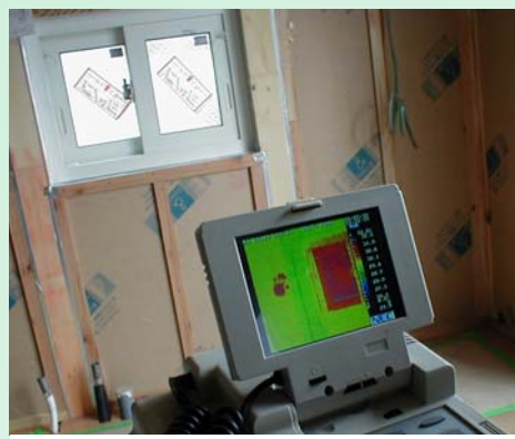
サーモグラフィで見ると壁が外気温に影響されていないことがわかります。
