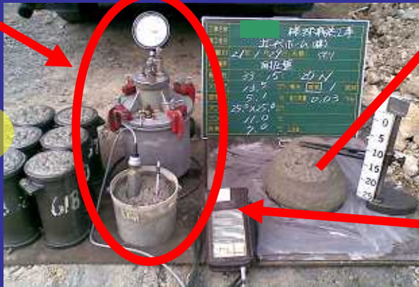
空気量と温度を測定します
